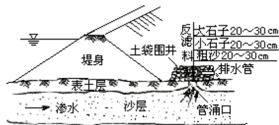
图 7 沙石反滤围井示意图
